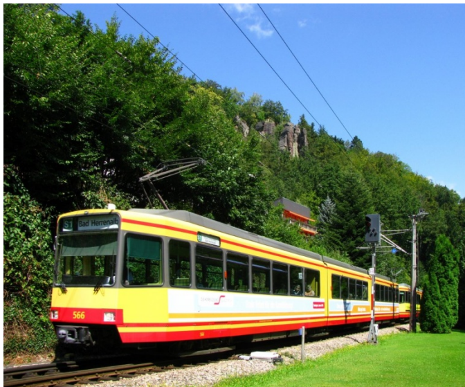
Duospårvagn i Karlsruhe i Tyskland med två strömförsörjningssystem
